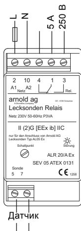
Рис. 14 Соединения реле ALR-20/A
