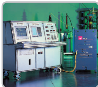
Проверка характеристик вакуумного автоматического выключателя
