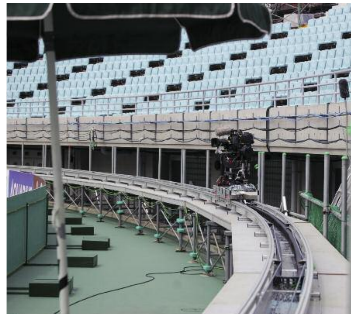
Применение конфекционированной igus® E6-System с камерой
