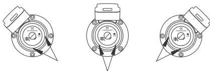
Рис. 5 Расположение клеммной коробки у одинарных насосов
