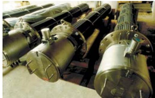
**TRHC / TRHCС Погружные нагреватели АТЕХ со сменными нагревательными элементами в защитном кожухе**
