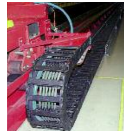
CF5/CF6 в складском подъемнике: длинное перемещение по продольной оси. Энергоцепь: серия E4/00 с igus® желобом из стали
