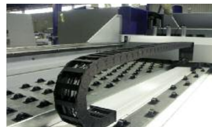
chainflex® CF130.UL в деревообработке. Энергоцепи E4/light
