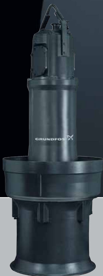
SA Высокомощные осевые насосы Q: до 12 000 м³/ч ≈ 3,500 л/с H: до 9,5 м
