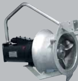
SRP Погружные рециркуляционные насосы Q: до 4680 м³/ч ≈ 1300 л/с H: до 1,5 м
