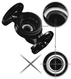
Рис. 16 Неправильно выровненная система уплотнений
