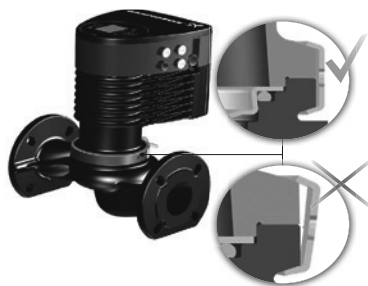
Рис. 17 Закрепление головной части насоса на корпусе
