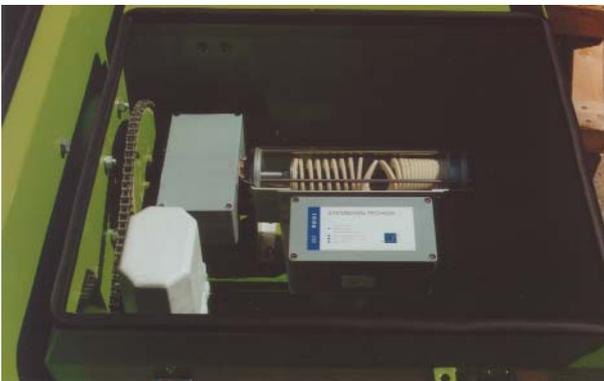
LWL-Drehübertrager für Leitungstrommeln bis zu 200 Umdrehungen
