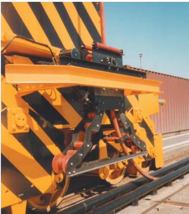
Mit Hilfe der Zugüberwachung wird ein zu starker bzw. ein zu geringer Leitungszug korrigiert. Hierbei wird die Leitung durch ein Pendel (4) geführt, welches über ein Gestänge mit einem Hebel-Endschalter (3) verbunden ist. Im Normalfall liegt das Pendel mit der Leitung am Rollenbogen der Umlenkvorrichtung an. Bei zu starkem Leitungszug schwenkt die komplette Umlenkvorrichtung incl. Pendel nach rechts bzw. links aus und wird gegen einen Federpuffer (5) gedrückt.
