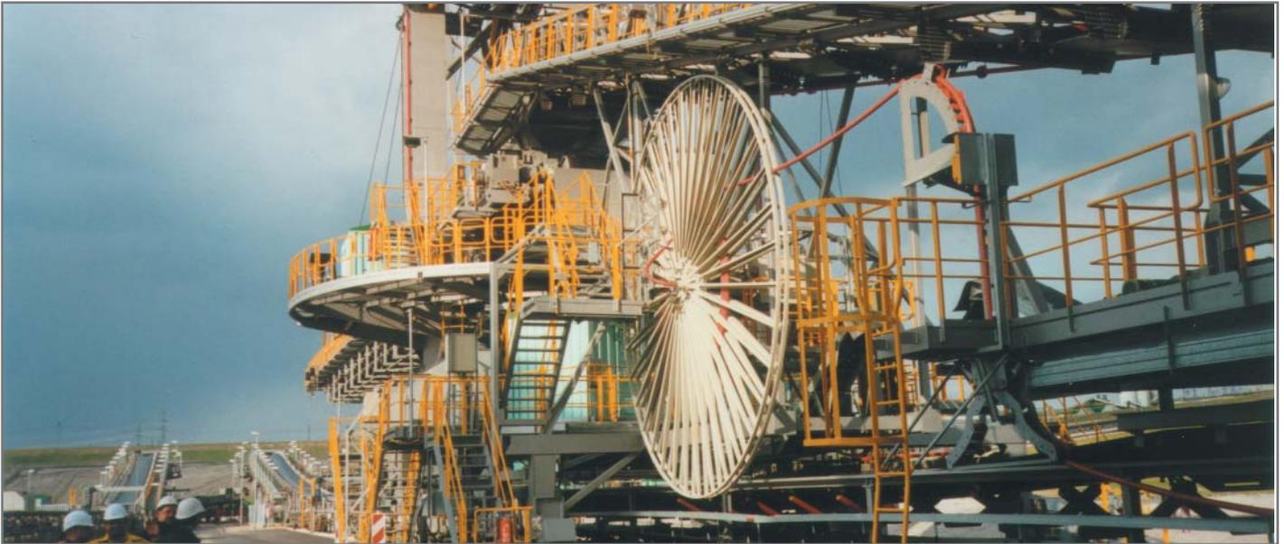
Das am meisten eingesetzte Zubehörteil - neben der aufzuwickelnden Leitung - ist die Umlenkvorrichtung. Sie wird bei einer spiraligen Leitungstrommel idealerweise unterhalb der Trommel platziert (siehe Skizze).
