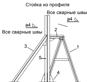
Рис. 20 Сварка стойки и опор
