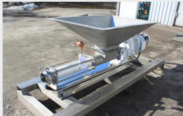
Данные насосы выполнены на специальной нержавеющей раме, которая имеет конструкцию позволяющую перевозить агрегат погрузчиком, либо имеет раму в мобильном исполнении (по желанию заказчика). Насос оборудован бункером подпорным шнеком и укомплектован пультом управления с преобразователем частоты, что позволяет точно настроить откачку пищевых отходов
