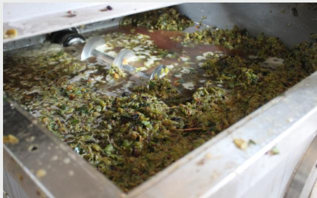
В рамках выполнения указанной задачи, специалистами компании SOLTEC ® Новомосковский Механический Завод подобран и изготовлен одновинтовой насос BN063L01FYBSM с производительностью 25 м<sup>3</sup>/ч и рабочим давлением до 4 бар.
