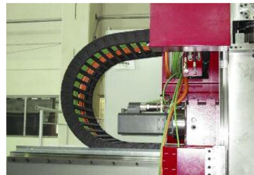
Предварительно конфекционированные igus® энергоцепи в станкостроении. Энергоцепь: системы E4/4
