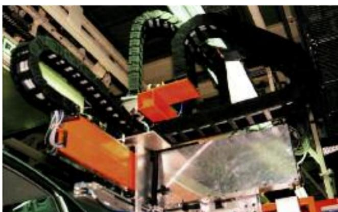
Три, оснащенные специальными кабелями igus® системы подачи энергии по нескольким осям.
