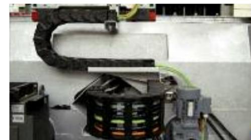
Системы readychain® igus® комплектно конфекционированные с кабелями chainflex®, шлангами, разъемами, металлическими конструкциями, и т.д.
