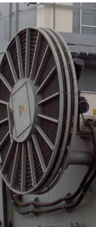
Сдвоенная катушка барабана моноспиральной намотки с двумя одинаковыми кабелями большого сечения
